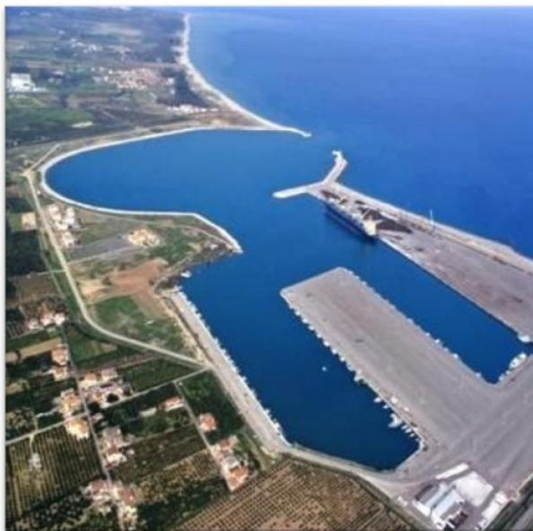
L'infrastruttura portuale inclusiva dello specchio acqueo, si estende su una superficie complessiva di circa 1.300.000 metri quadrati e si articola in un bacino di evoluzione, 7 banchine e 2 darsene disposte in parallelo secondo la linea di costa.
